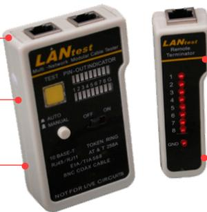
Capaz de realizar pruebas de continuidad de cable en coaxial BNC.
